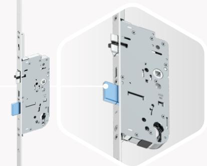
Glavni ježičak automatski pokreće mehanizam zatvaranja čim se vrata zatvore. Osim toga jedan magnetni pokretač izaziva korektno zatvaranje; dva kriterija za sigurno zatvaranje. Automatski zaključavaju dva kljuna i što je jedinstveno također i centralni zasun. Vrata su trostruko zaključana, a sve bez ključa. Moguća je i ugradnja dodatnih komponenti zaključavanja.
