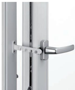
Гребенка монтируется на поворотные и поворотно-откидные окна из ПВХ и дерева. На ней имеются четыре паза для разных уровней открывания. Применяется как слева, так и справа. Крепится на оконной раме. Второй элемент гребенки монтируется под ручкой.
