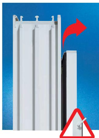
В весенние и осенние месяцы, в периоды межсезонья микропроветривание является оптимальным решением для достаточного воздухообмена. В положении ручки под углом 45° створка отходит от рамы на 10 и 12 мм посредством вмонтированных ножниц.
