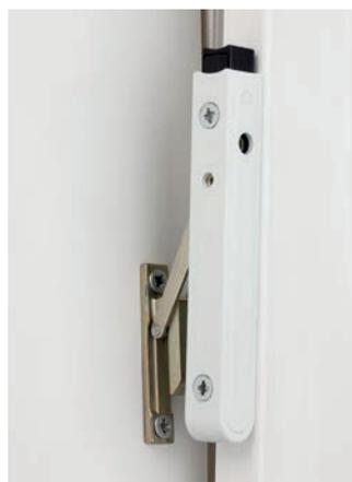
В поворотном и поворотно-откидном окне MULTI-Vent обеспечивает возможность проветривания за счёт раскрывающегося фиксирующегося плеча, спрятанного под декоративным кожухом. Благодаря встроенному подтормаживателю створка открывается на нужное расстояние.
