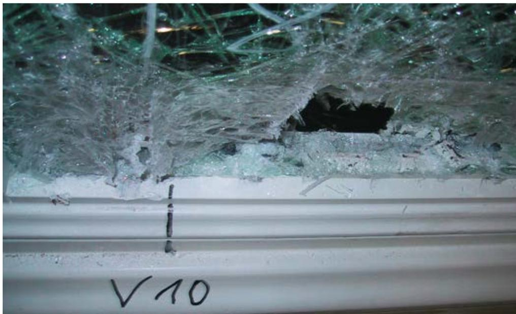
Prova: fissaggio del vetro
