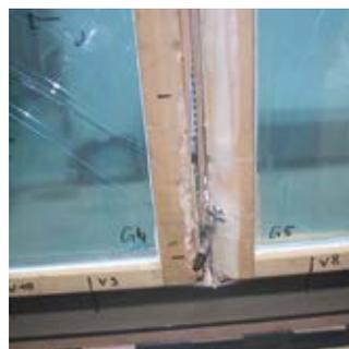
Una prova di scasso su una finestra ad anta-ribalta fotografata dall'esterno. La forbice del meccanismo del battente secondario è stata forzata verso l'esterno ma non ha potuto essere sbloccata. Tutti i perni s.i. (sicurezza intelligente) continuano a far presa perfettamente nei dispositivi di chiusura. Non è stato ricavato alcun varco accessibile nei tre minuti di tempo concessi per la prova di scasso.
