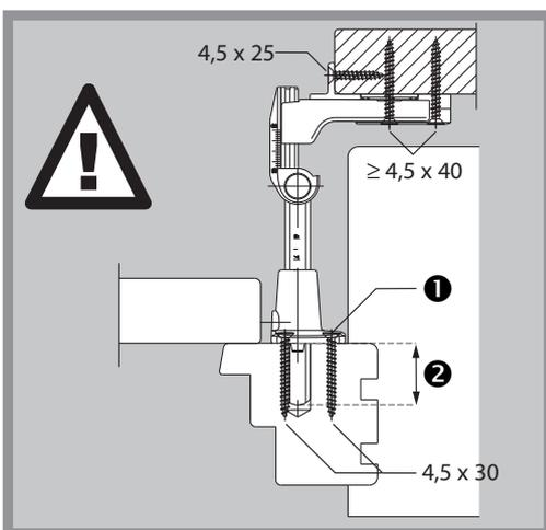
1 - In Kombination mit Rasthalter  $\geq$  4,5 x 40 mm
