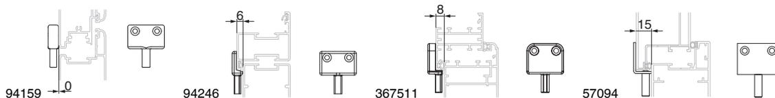
**7.3.8.1 Schließzapfenplatten R8 für Blendrahmenmontage**
