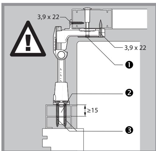
1 - Befestigungsschraube mit Gewindehülse
