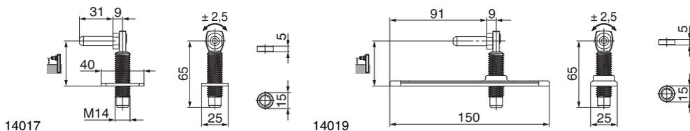
**3.3.1.4 Plattenkloben MV mit Gewinde und Seitenregulierung**
