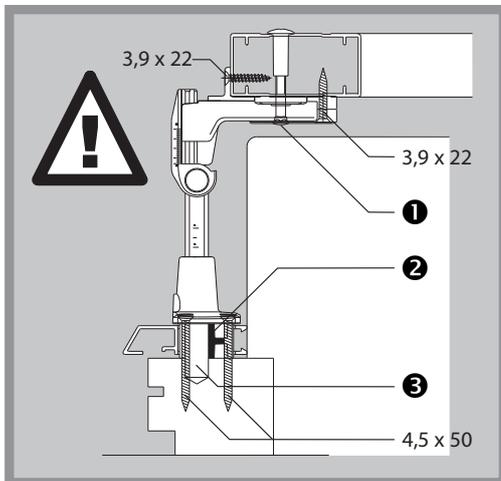
1 - Befestigungsschraube mit Gewindehülse
