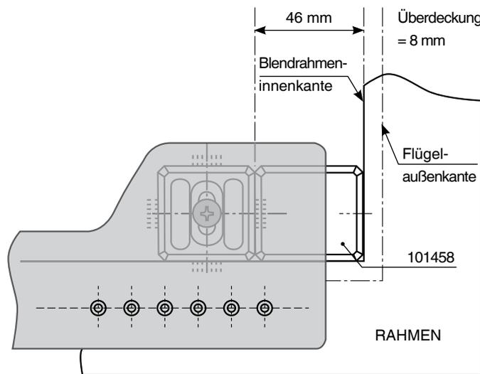
Beim Anschlag des Kippflügelbandes ist bei einer Falzlufth 12 mm und einem Überschlag von 20 mm ein Distanzmaß von 46 mm zu berücksichtigen!
