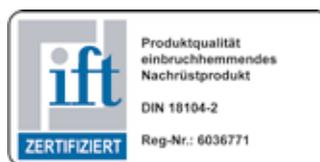
La norma DIN 18104 Apartado 2 se refiere a los productos que pueden ser montados a posteriori en el canal de ventana y puerta. Por lo tanto, el montaje de estos elementos en sistemas oscilobatientes con anti-efracción debe cumplir este apartado 2 de la norma 18104..
