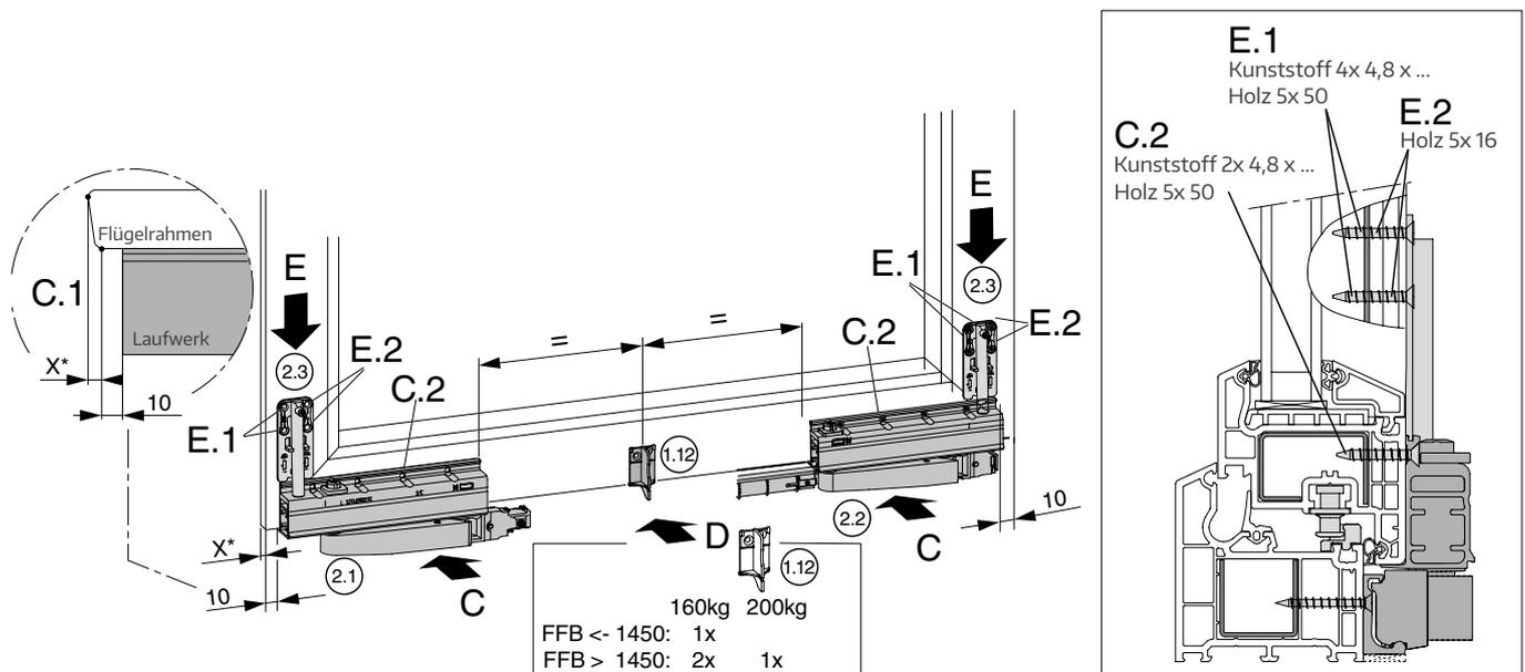
\*) Bestimmung von X ist nötig für die spätere Montage des Steuerklotzes
