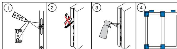
1. Graisser toutes les parties mobiles et les zones de verrouillage du ferrage périphérique. Ne pas utiliser d'huile de graissage, de dégrissant, de spray silicone etc... ! Graissage uniquement avec de la graisse ou de la vaseline technique !
