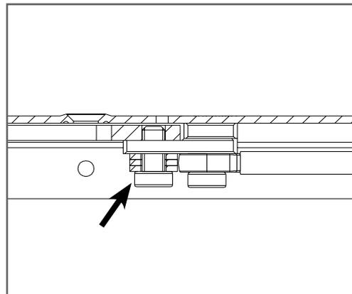
4. Getriebestulp und Dämpfer mit Spannstift verbinden
