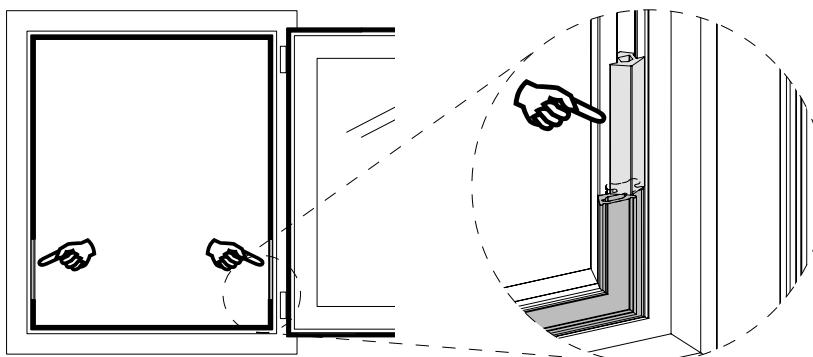
2. Inserire la guarnizione sostitutiva nel telaio
