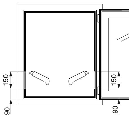
1. Anschlagdichtung am Blendrahmen ausnehmen
