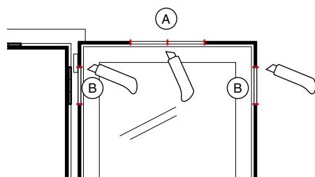
8. Ersatzdichtung in Flügel einsetzen
