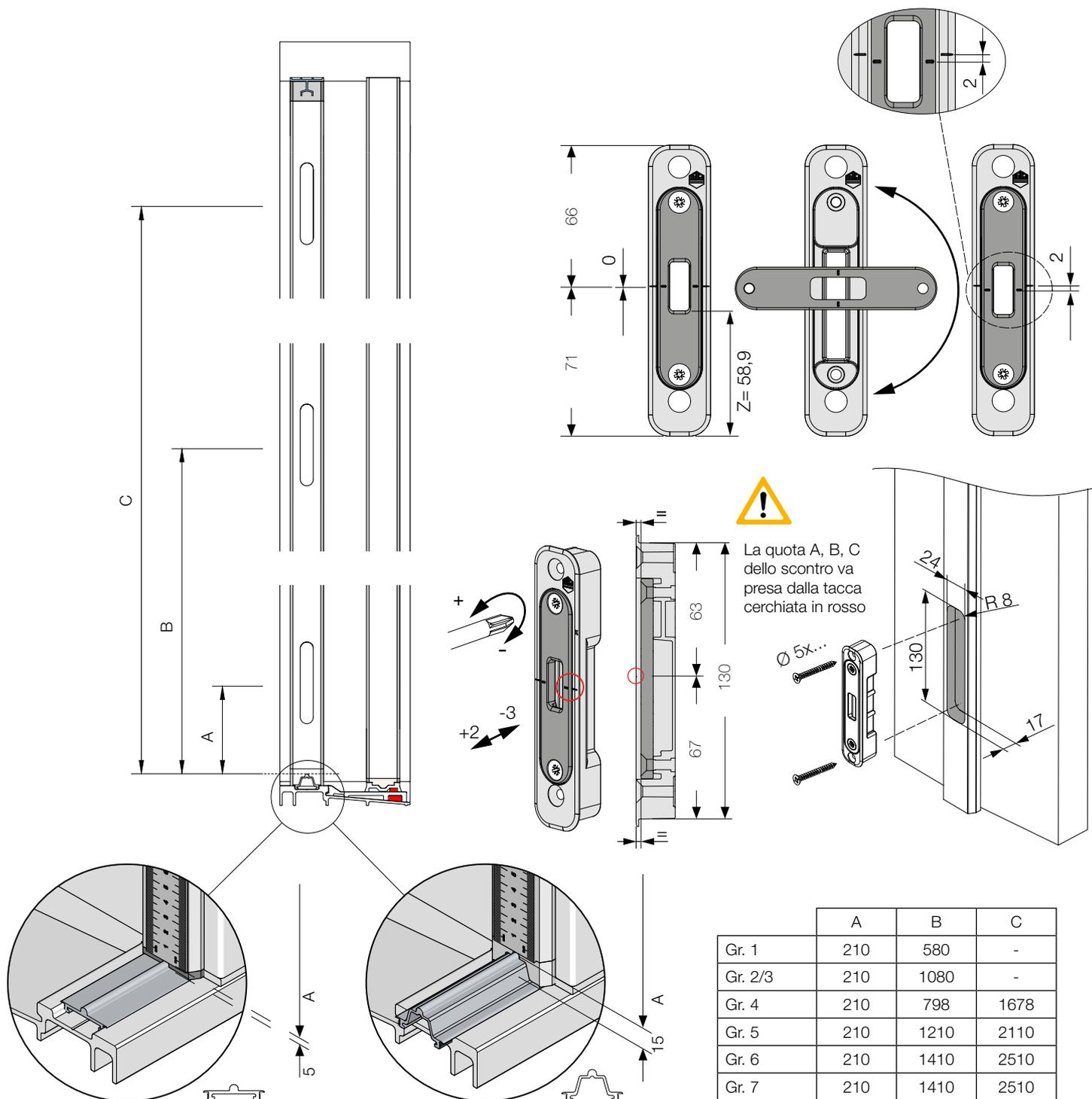
Assemblaggio anta mobile e telaio
