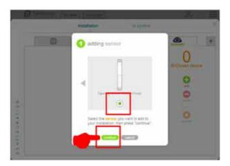
> Sensor anlernen (lt. Anleitung = Magnet über Reedkontakt bzw. 3mal kurz drücken), die Erkennung des Sensors wird bestätigt.
