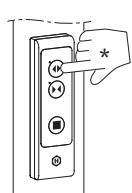
Taste „AUF“ drücken: der Schiebeflügel muss „AUF“ fahren. Der Flügel fährt ca. 100 mm und hält dann automatisch an. Wenn der Flügel „ZU“ fährt, muss auf S2 die Position des DIP-Schalters 1 kontrolliert werden.
