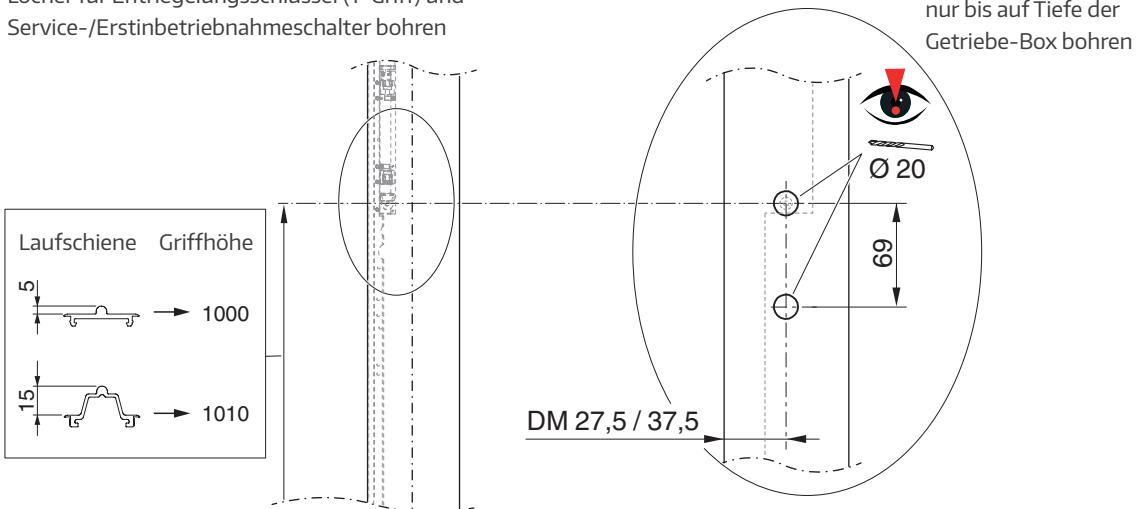
Löcher für Abdeckung manuelle Ent-/Verriegelung bohren
