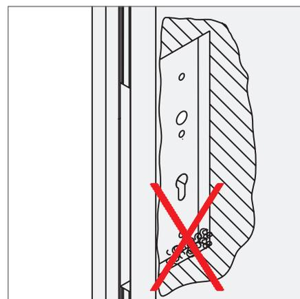
Späne aus Frästasche entfernen!
