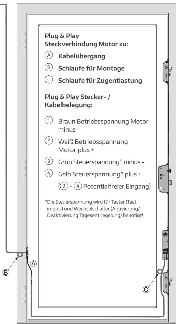
**Plug & Play Steckverbindung Motor zu:**
