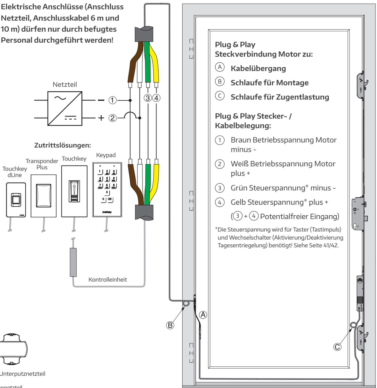
\*\*Es wird empfohlen, das A-TS mit motorischer Öffnung nur mit hierfür vorgesehenen, geprüften und freigegebenen Netzteilen zu betreiben. Diese sind für eine Eingangsspannung von 220-240V/50-60Hz konzipiert und leisten eine Ausgangsspannung von 24 V DC 1A mit dynamischen Überstrom 3A für 500ms/ 7A für 100ms. Alternativ müssen Fremdprodukte eine Ausgangsspannung von 12 - 24 V DC mit mind. 1,5A aufweisen.
