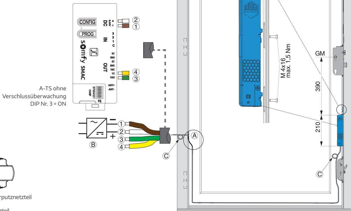
\*\*Es wird empfohlen, das A-TS mit motorischer Öffnung nur mit hierfür vorgesehenen, geprüften und freigegebenen Netzteilen zu betreiben. Diese sind für eine Eingangsspannung von 220-240V/50-60Hz konzipiert und leisten eine Ausgangsspannung von 24 V DC 1A mit dynamischen Überstrom 3A für 500ms/ 7A für 100ms. Alternativ müssen Fremdprodukte eine Ausgangsspannung von 12 - 24 V DC mit mind. 1,5A aufweisen.
