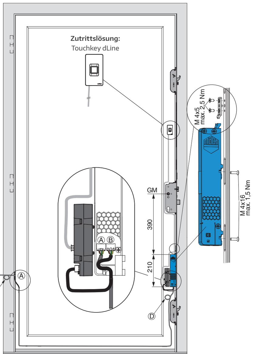
\*\*Es wird empfohlen, das A-TS mit motorischer Öffnung nur mit hierfür vorgesehenen, geprüften und freigegebenen Netzteilen zu betreiben. Diese sind für eine Eingangsspannung von 220-240V/50-60Hz konzipiert und leisten eine Ausgangsspannung von 24 V DC 1A mit dynamischen Überstrom 3A für 500ms/ 7A für 100ms. Alternativ müssen Fremdprodukte eine Ausgangsspannung von 12 - 24 V DC mit mind. 1,5A aufweisen.
