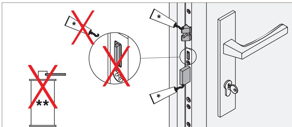
La scatola serratura viene fornita con una lubrificazione costante con grassi di alta qualità, di conseguenza NON è necessario lubrificarla nuovamente!
