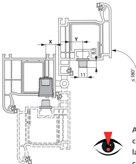
A causa dei diversi tipi di passacavo con differenti ASSI DI ROTAZIONE, la posizione della vaschetta per il cavo (dimensione X) e della copertura (dimensione Y) deve essere calcolata individualmente caso per caso!
