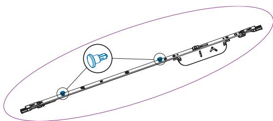
La prolunga con punto di chiusura viene fornita con due perni di bloccaggio premontati!
