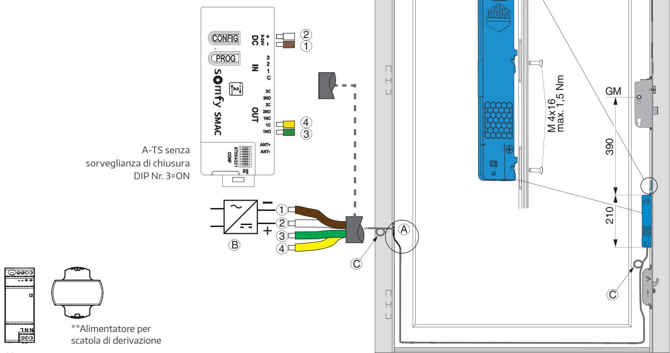
\*Si raccomanda di utilizzare la serratura autobloccante A-TS con apertura motorizzata solo con alimentatori testati e approvati per questo scopo. Questi sono progettati per una tensione di ingresso di 220-240V / 50-60Hz e forniscono una tensione in uscita di 24 V DC 1A con sovraccorrente dinamica 3A per 500ms/ 7A per 100ms. In alternativa, i prodotti di terzi devono avere una tensione di uscita di 12 - 24 V DC con almeno 1,5A.
