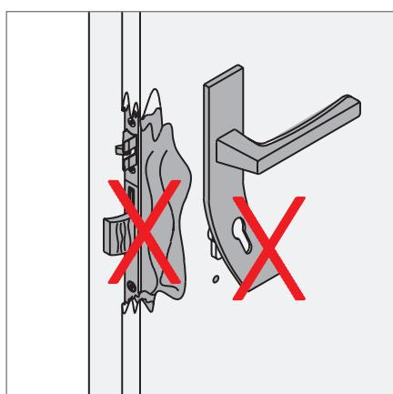
La serratura multi punto deve essere sostituita ai primi segni visibili di forzatura o effrazione!
