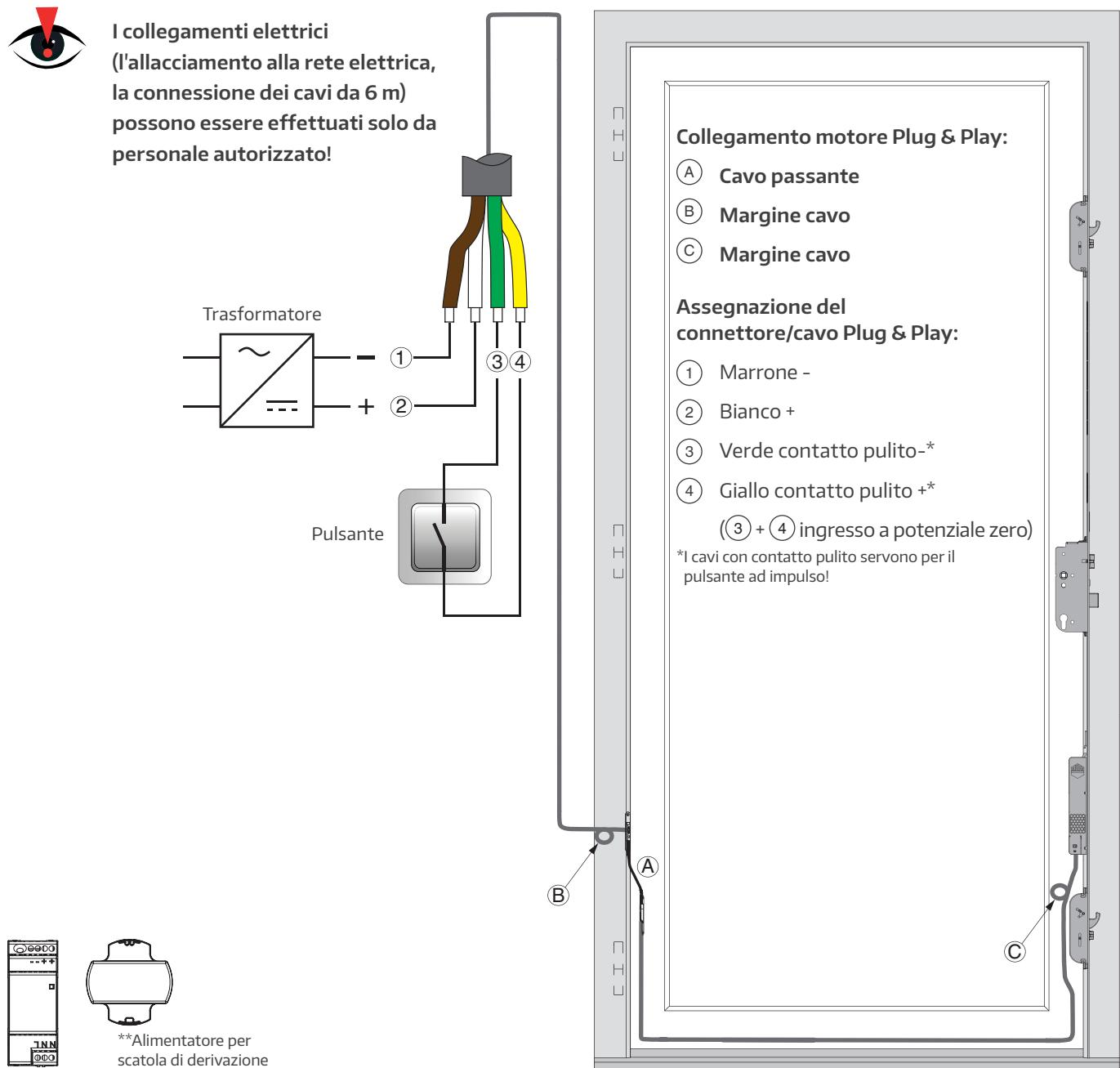
\*Si raccomanda di utilizzare la serratura autobloccante A-TS con apertura motorizzata solo con alimentatori testati e approvati per questo scopo. Questi sono progettati per una tensione di ingresso di 220-240V / 50-60Hz e forniscono una tensione in uscita di 24 V DC 1A con sovraccorrente dinamica 3A per 500ms/ 7A per 100ms. In alternativa, i prodotti di terzi devono avere una tensione di uscita di 12 - 24 V DC con almeno 1,5A.
