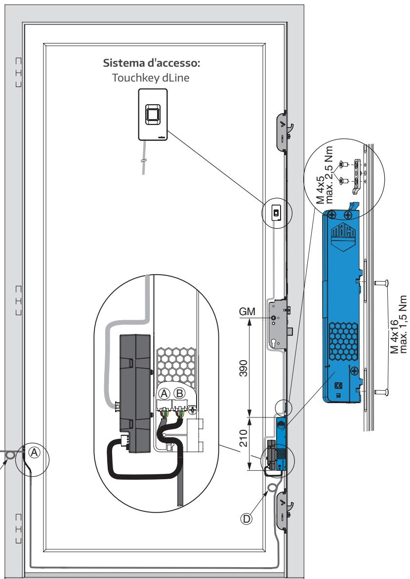
\*\*Si raccomanda di utilizzare la serratura autobloccante A-TS con apertura motorizzata solo con alimentatori testati e approvati per questo scopo. Questi sono progettati per una tensione di ingresso di 220-240V / 50-60Hz e forniscono una tensione in uscita di 24 V DC 1A con sovraccorrente dinamica 3A per 500ms/ 7A per 100ms. In alternativa, i prodotti di terzi devono avere una tensione di uscita di 12 - 24 V DC con almeno 1,5A.
