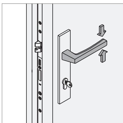
Gravare sulla maniglia soltanto nel normale senso di rotazione. Nella direzione di azionamento (sulla maniglia) applicare una forza massima di 15 kg!
