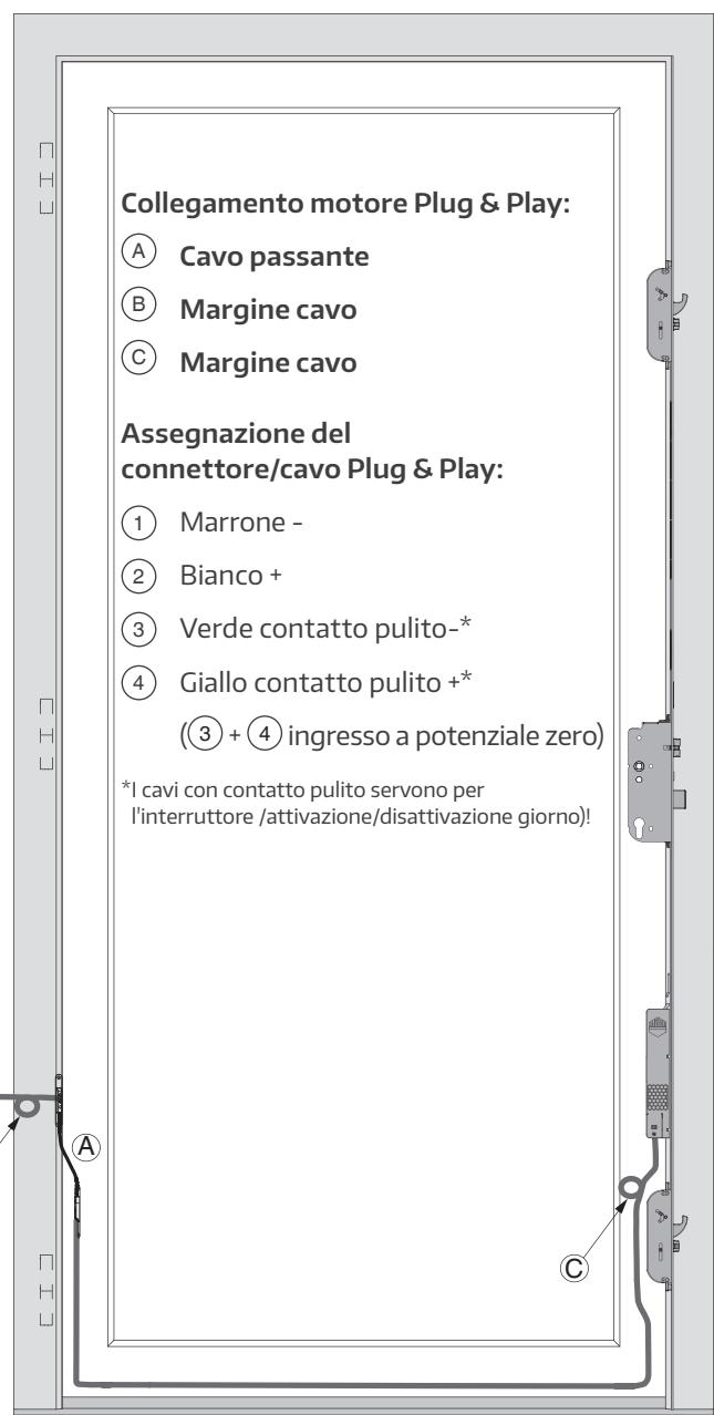
\*\*Si raccomanda di utilizzare la serratura autobloccante A-TS con apertura motorizzata solo con alimentatori testati e approvati per questo scopo. Questi sono progettati per una tensione di ingresso di 220-240V / 50-60Hz e forniscono una tensione in uscita di 24 V DC 1A con sovraccorrente dinamica 3A per 500ms/ 7A per 100ms. In alternativa, i prodotti di terzi devono avere una tensione di uscita di 12 - 24 V DC con almeno 1,5A.
