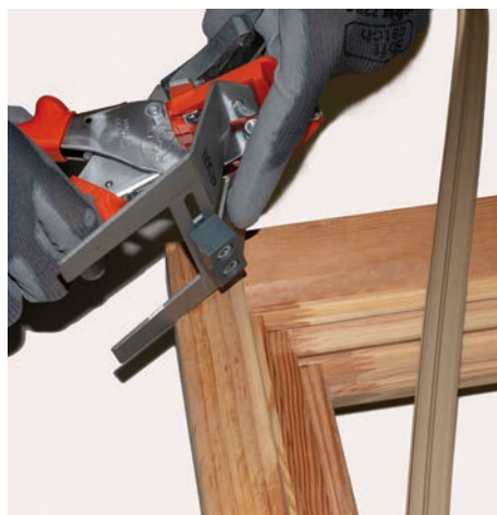
Posicionar la referencia de corte y la cuchilla correctamente para el corte en "Y"
