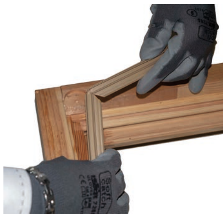
Posicionar la referencia de corte y la cuchilla correctamente para el corte en "Y"
