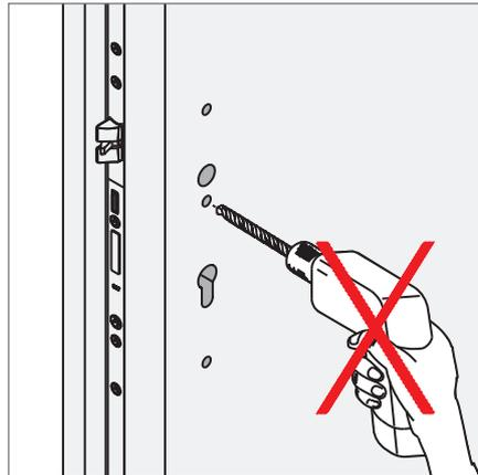
Alle Bohrungen vor Einbau des Schlosses durchführen!
