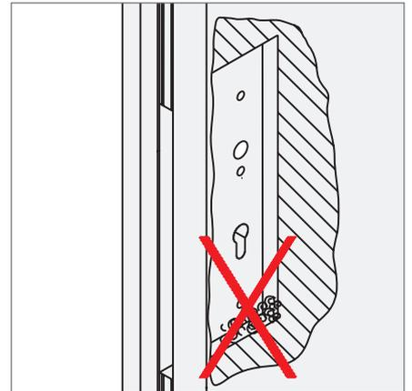
Späne vor Einbau des Schlosses aus Frästasche entfernen!
