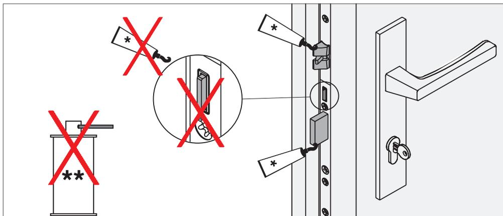
**Das Türschloss (Schlosskasten) wird mit einer Dauerschmierung aus Hochleistungsfetten geliefert und darf NICHT nachgeschmiert werden! Lediglich Falle und Sperrriegel 1 x jährlich schmieren!**
