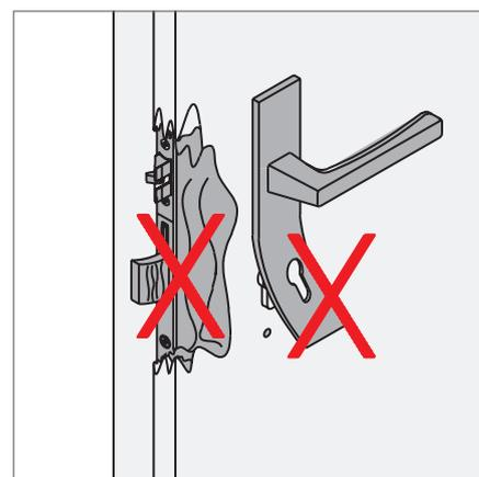
Die Mehrfachverriegelung ist auszutauschen, sobald Spuren von Gewaltanwendung sichtbar sind!
