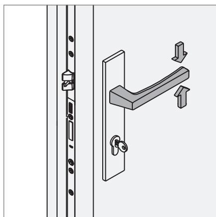
Drücker nur in normalen Drehsinn belasten! In Betätigungsrichtung (auf den Drücker) maximal eine Kraft von 15 kg aufbringen!
