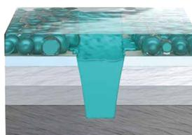
... füllen die in den Nanokapseln enthaltenen Stoffe die Kratzer auf und stellen so den Korrosionsschutz wieder her.
