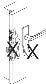
Ai primi segni visibili di forzatura o effrazione, cambiare la serratura.
