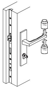
Azionare la martellina solo nel normale senso di apertura, agendo con una forza non superiore ai 15 Kg.
