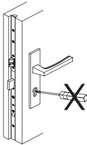
Azionare la serratura unicamente con la chiave appropriata.
