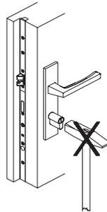
Non sforzare o montare il cilindro con strumenti inadeguati.
