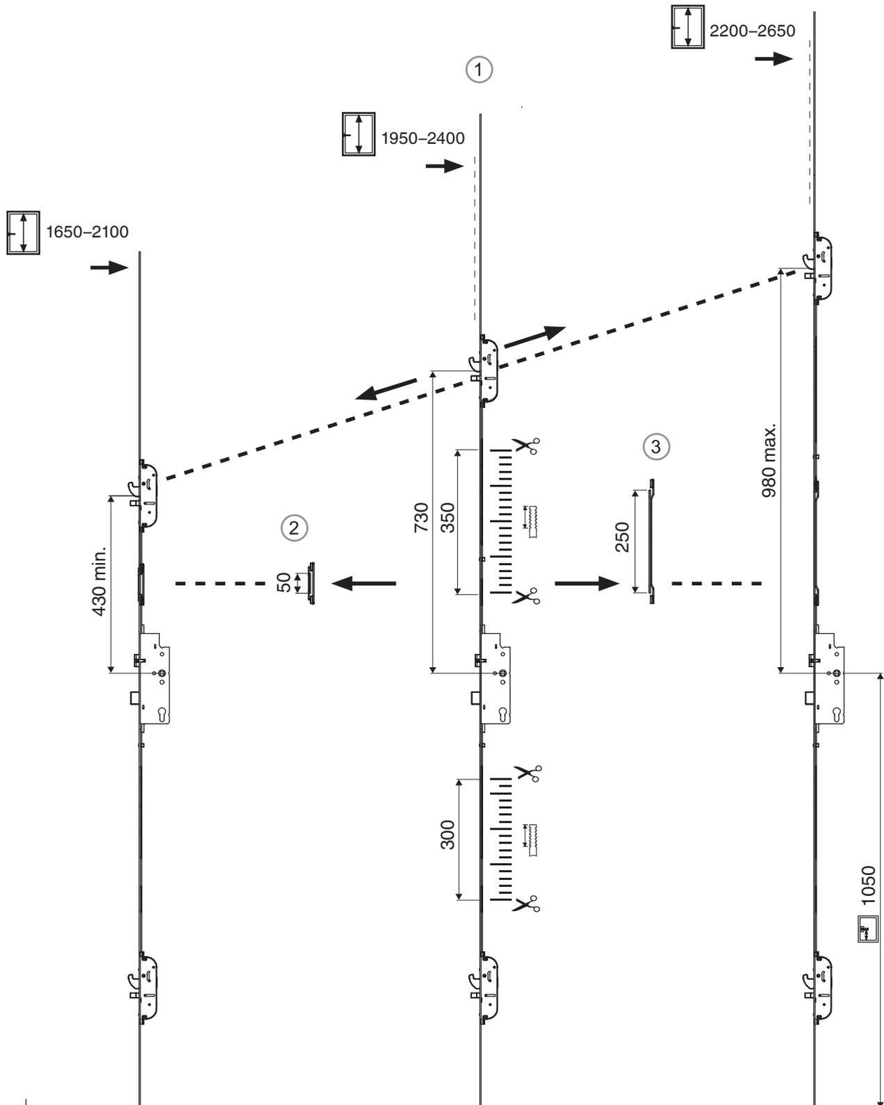
Soluzione 'extra' mediante inserimento di componente intermedio
