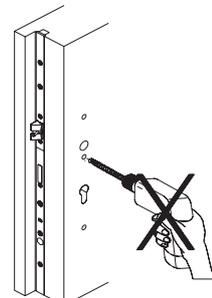
Praticare tutte le forature prima del montaggio della serratura.
