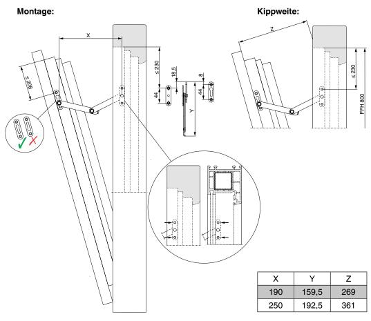
(A) Schrauben so lange wie möglich, mindestens  $\emptyset$  4x45 mm. Bei Kunststoffprofilen muss in die Armierung verschraubt werden!
