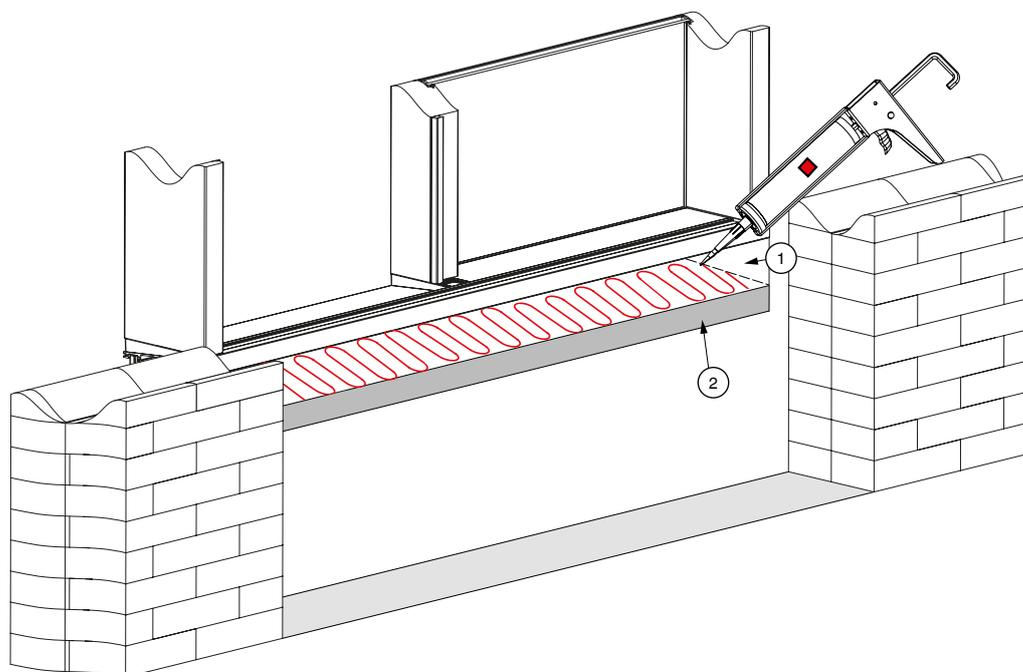
b) Element auf Aufdopplungsprofil befestigen
