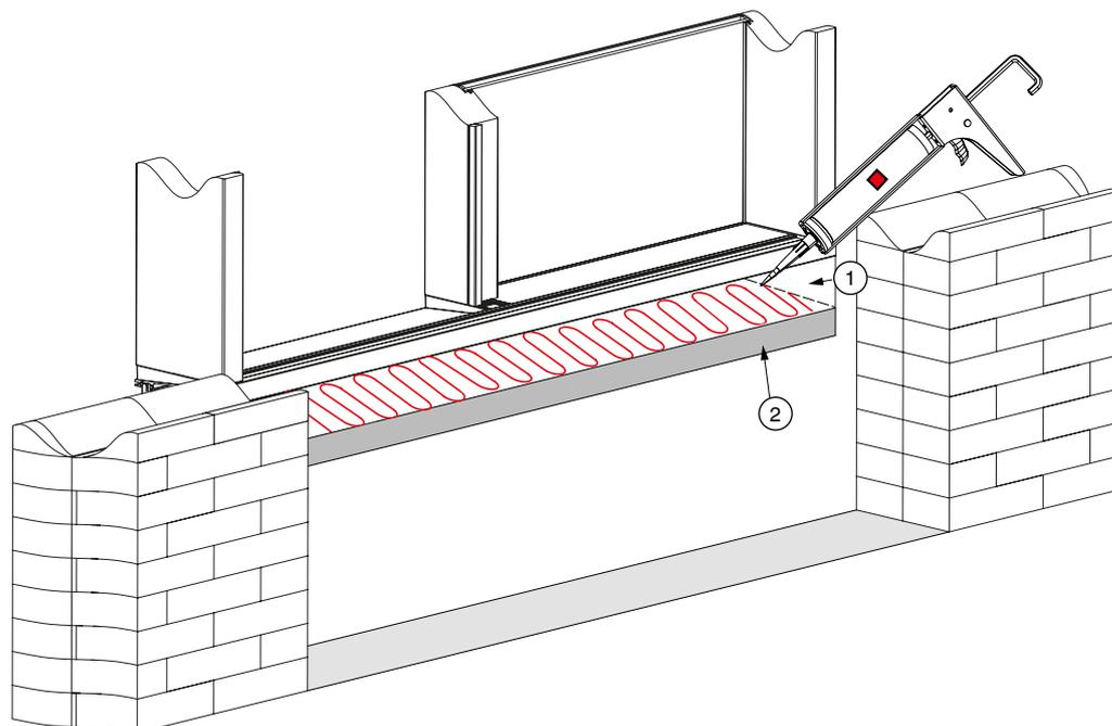
b) Element waagrecht ausrichten und verklotzen
