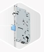
Die Hauptfalle löst automatisch den Verriegelungsmechanismus aus, sobald die Tür ins Schloss fällt. Zusätzlich überwacht ein Magnetauslöser das korrekte Schließen: zwei Kriterien für eine sichere Verriegelung. Zwei Haken und – das ist einzigartig – auch der Sperrriegel fahren automatisch aus. Die Tür ist dreifach verriegelt, ohne Schlüssel. Zusätzliche Verriegelungspunkte sind möglich.
