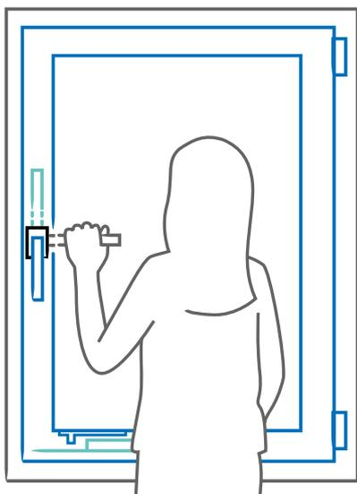
Prozorski senzor ugrađuje se s magnetom u okvir prozora. Okretom ručke pokretni magnet prolazi sredinom preko senzora, time prepoznaje uredno rukovanje te daje informaciju je li prozor otvoren, zatvoren ili otklopljen.
