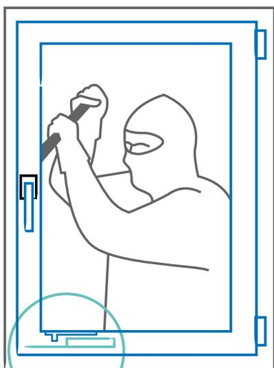
Prilikom pokušaja nasilnog otvaranja prozora, magnet se okreće okomito od bežičnog senzora koji onda prepoznaje promijenjen i nepravilan smjer i aktivira alarm.
