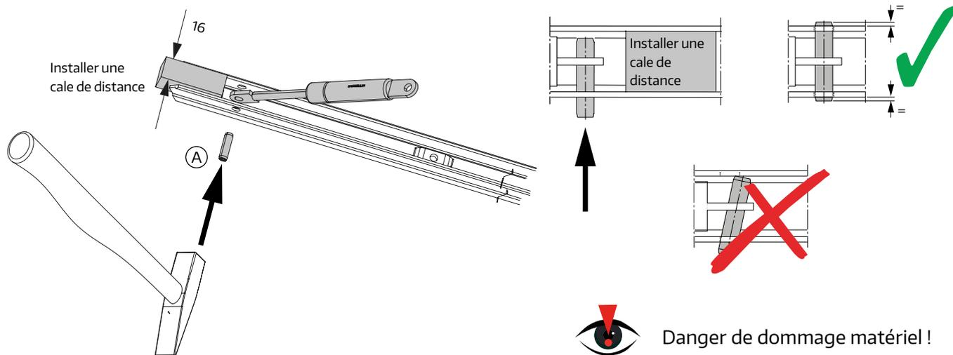
Ⓑ Mettre le ressort à gaz en place et le fixer à l'aide de la vis.
