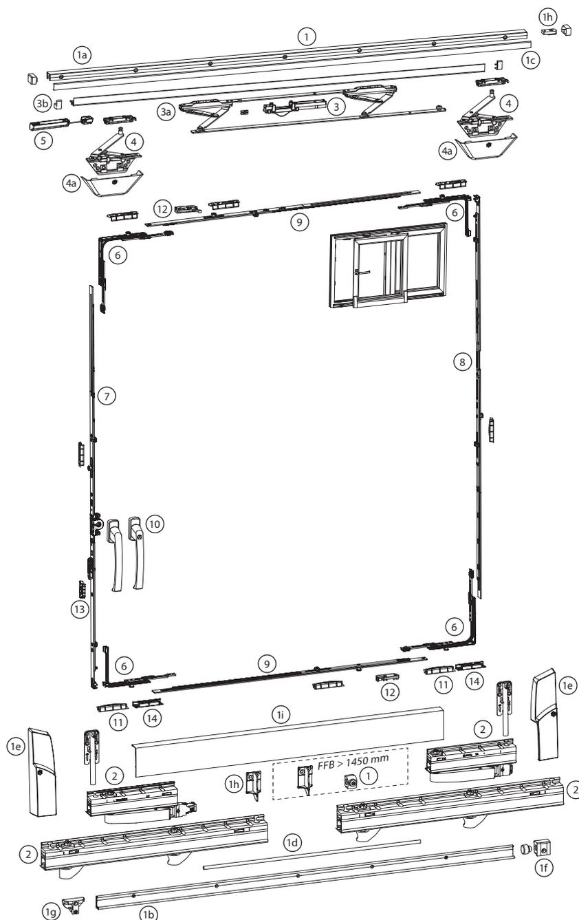
Der Schiebekipp-Beschlag SKB-Upgrade ist für die Realisierung von Schiebekipp-Fenster- und Fenstertüren für alle üblichen Fensterprofile aus Holz, Kunststoff oder Holz/Alu geeignet.
