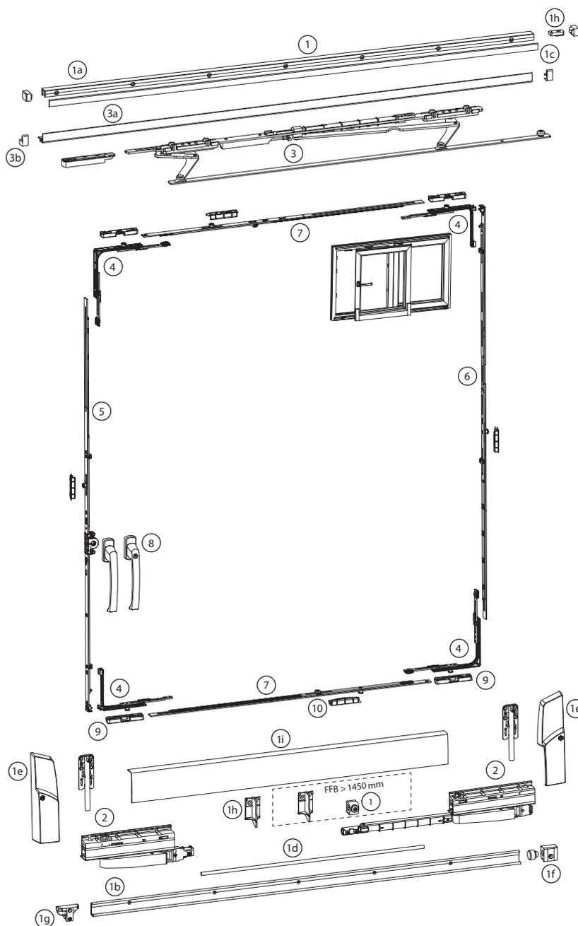
Der Parallel - Abstell - Schiebe Beschlag PAS ist für die Realisierung von Parallel - Schiebe - Fenstern-und Fenstertüren für alle üblichen Fensterprofile aus Holz, Kunststoff oder Holz/Alu geeignet.
