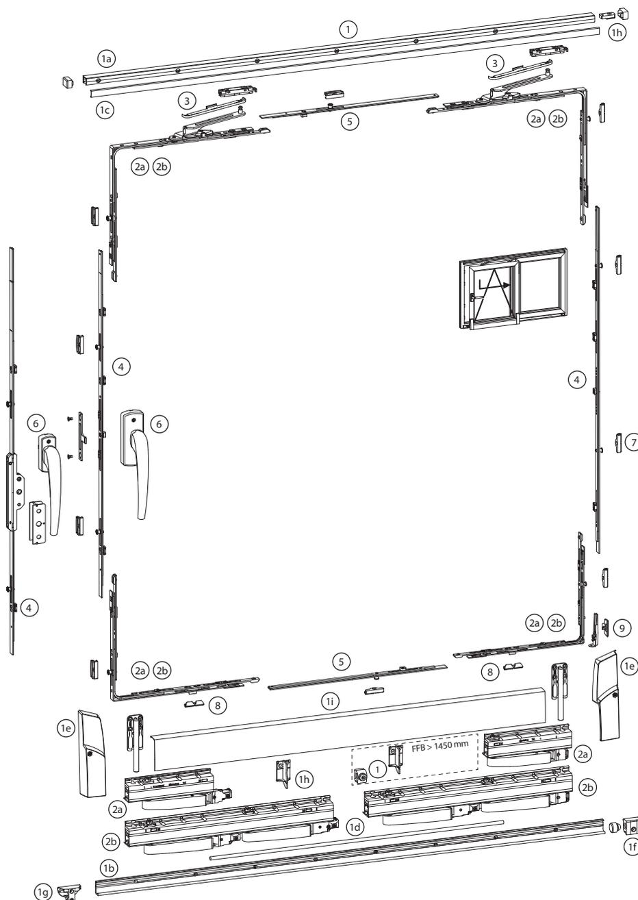
Der Schiebekipp-Beschlag SKB-Z ist für die Realisierung von Schiebekipp-Fenstern und Fenstertüren mit Zwangssteuerung vorgesehen und ist für alle üblichen Fensterprofile aus Holz, Kunststoff oder Holz/Alu geeignet.
