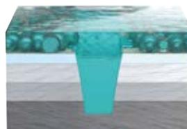
...le sostanze contenute nelle nanocapsule riempiono i graffi e ripristinano così la protezione anticorrosione.
