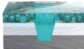
... los materiales contenidos en las nanocápsulas rellenan el arañazo y restablecen así la resistencia frente a la corrosión.
