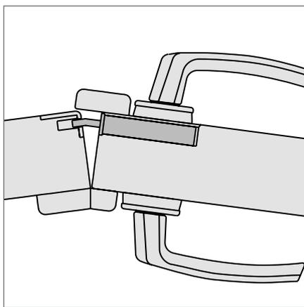
Les portes à double battant ne doivent pas être forcées sur le battant fixe !
