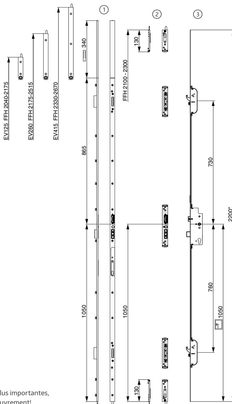
\*pour des dimensions HFF plus importantes, utilisez des têtes de recouvrement!
