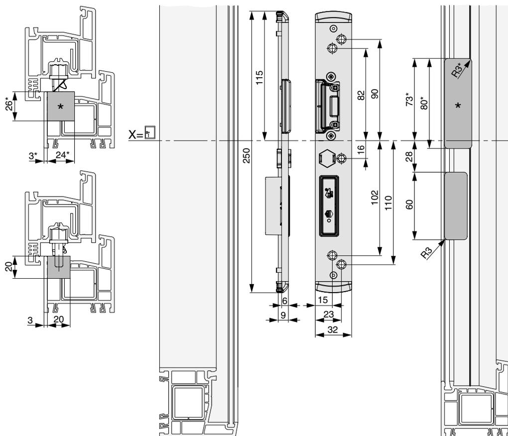
\*Schéma de fraisage gâche électrique
