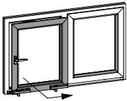
Flügel öffnen. Die Laufwerksicherung jeweils in die entsicherte Position bringen (S. 36, A). Auslösestift\* von unten in die Gleiteröffnung neben dem Sicherungsschieber bündig eindrücken (1).
