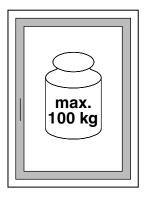
Si applica il diagramma del campo di applicazione del MULTI POWER, ma con un peso massimo dell'anta di 100 kg! con asta di sostegno
