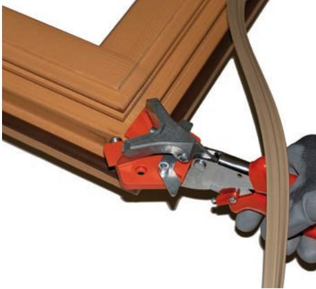
Positionierung der Platte am Anschlag
