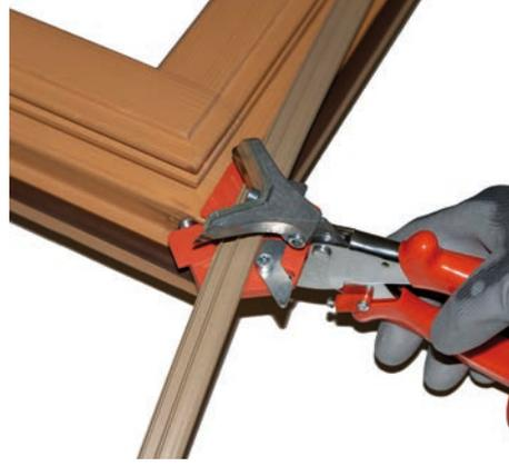
Dichtung in der korrekten Position klinken
