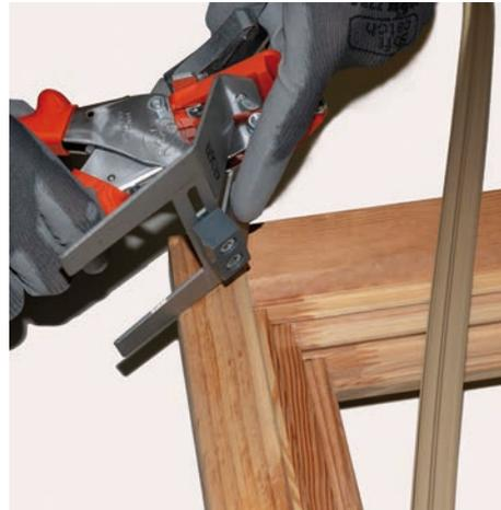
Schnittreferenzen und Messer für den "Y" - Schnitt korrekt positionieren
