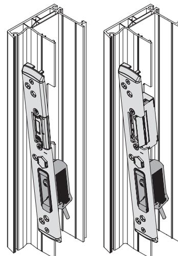
7. Selon les besoins, retirer la vis de réglage du point de commutation. dévisser partiellement ou enlever complètement si nécessaire.
