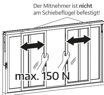
Schiebeflügel per Hand auf Leichtgängigkeit kontrollieren (mechanische Bedienkraft: max. 150 N)
