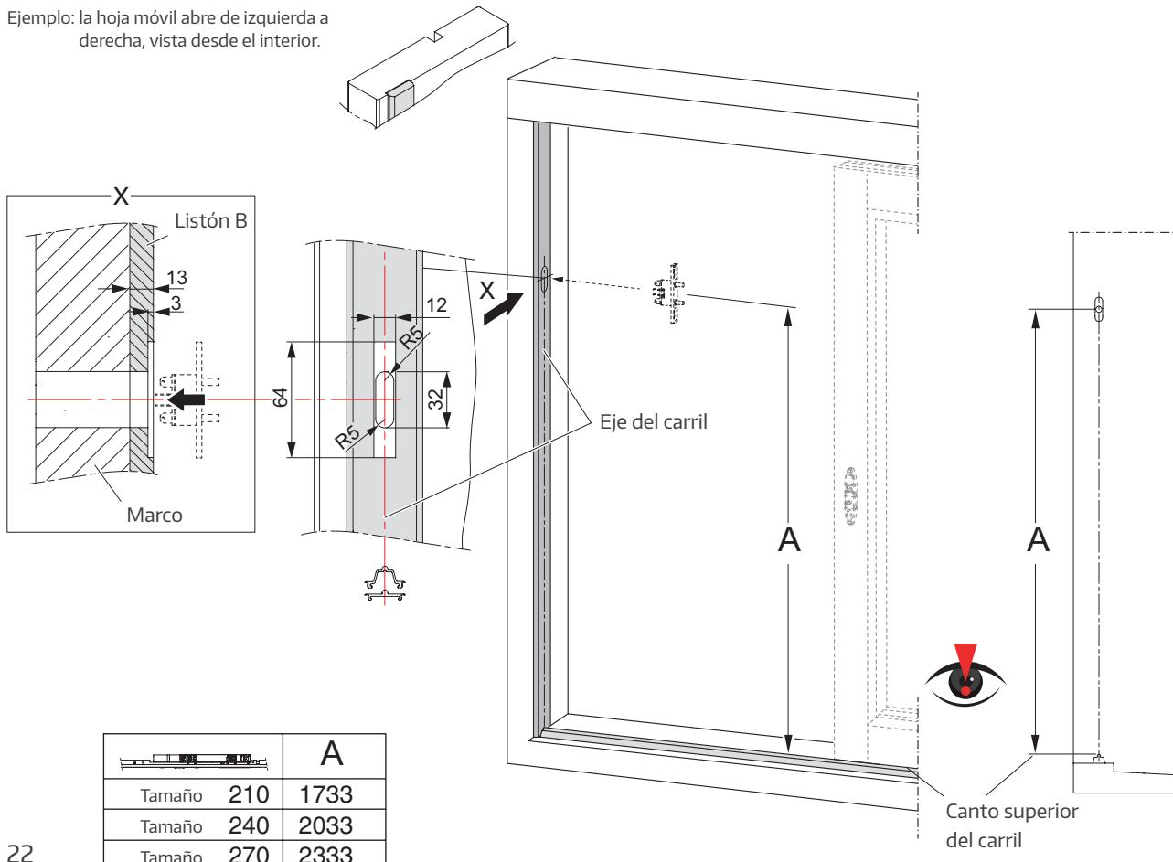
Con cerraduras de ganchos: fresados para la cerradura motorizada **(A)** **(B)**,
