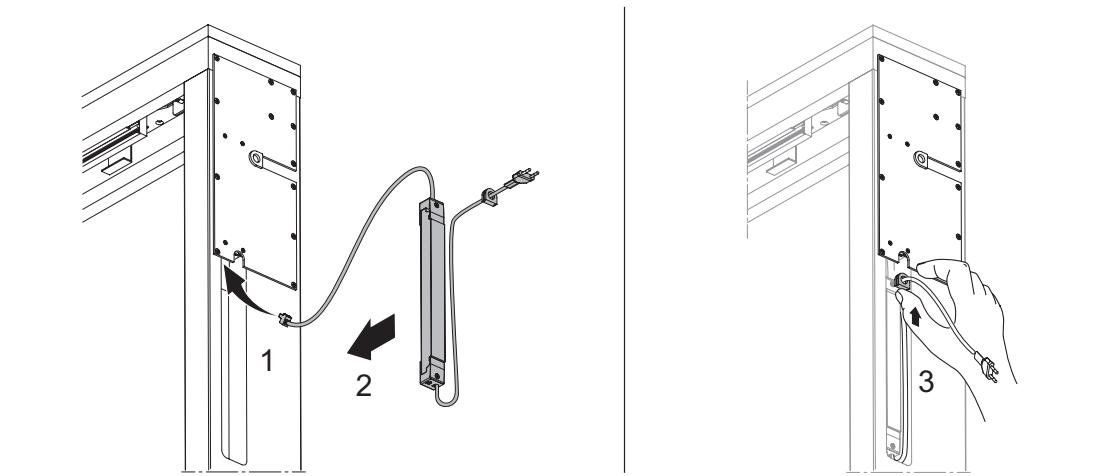
Coloque la tapa del transformador tocando la tapa de la centralita.
