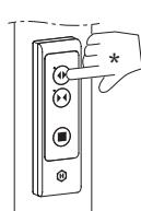
Pulse el botón "ABRIR": la hoja móvil debería abrirse durante aprox. 100 mm y luego pararse de forma automática. Si la hoja en cambio se mueve para cerrarse, deberá cambiar la posición del interruptor DIP 1 del selector S2.
