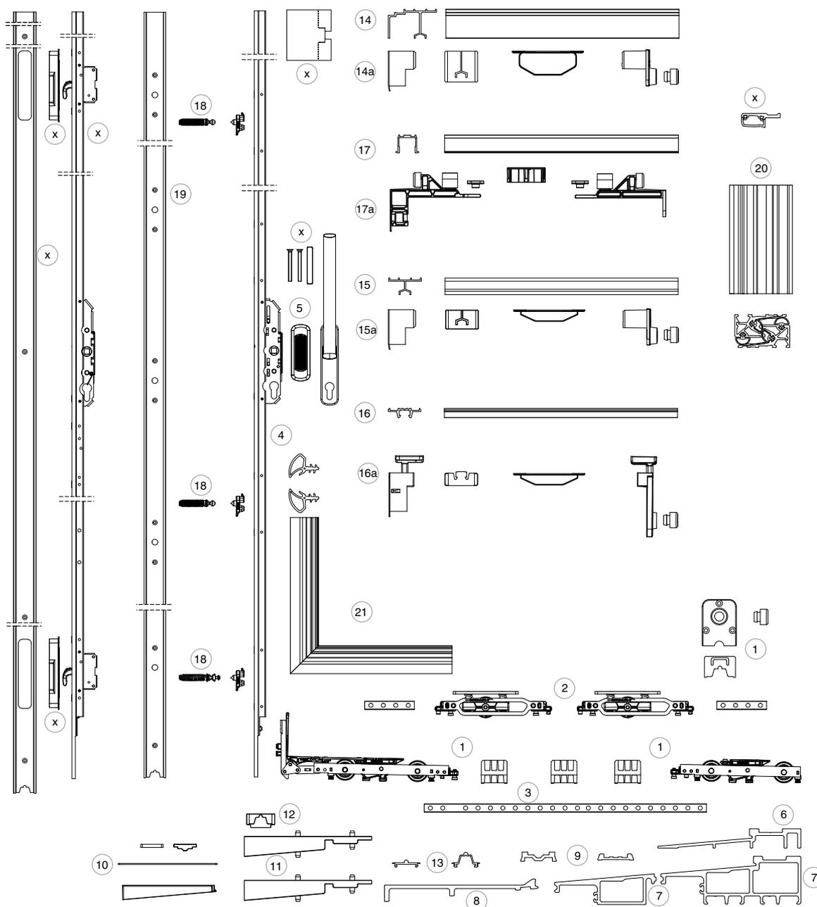
Der Hebe-Schiebe-Beschlag Standard HS-ST ist für die Realisierung von Hebe-Schiebe-Fenstern und - Fenstertüren für alle üblichen Fensterprofile aus Holz, Kunststoff oder Holz/Alu geeignet.
