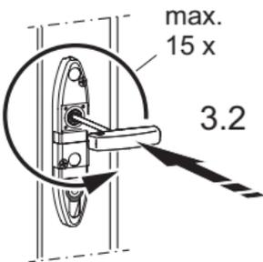
Notentriegelung mit leichtem Druck in Richtung Flügel und mit max. 15 vollen Umdrehungen gegen den Uhrzeigersinn hochdrehen (gilt für nach links und rechts öffnende Flügel), bis sich der Flügel schieben lässt (nach einigen Umdrehungen jeweils testen). Sollte die Notentriegelung „überspringen“, so ist der Druck in Richtung des Flügels zu erhöhen.
