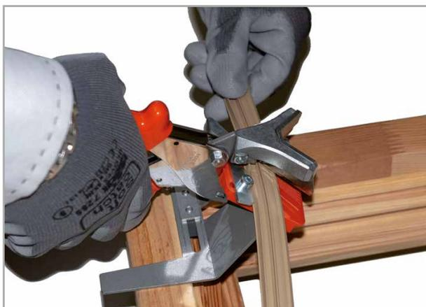
3. Coloque las tenazas en la zona de corte, pellizque la junta y retire el residuo de corte.
