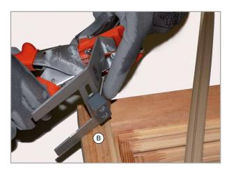
2. Régler la butée B et la position de la lame.
