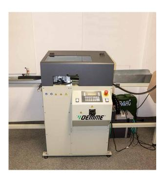
Grâce à des installations de soudage adaptées, entièrement ou partiellement automatisées, il est possible de fabriquer sur mesure des cadres précis avec quatre angles parfaitement soudés.
