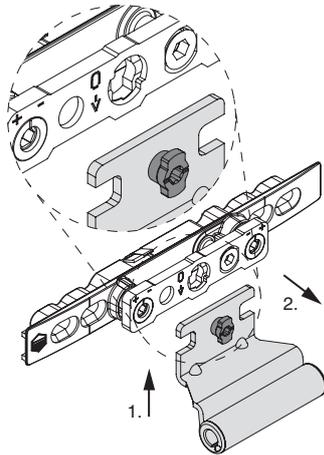
Bandwinkel in das Kipp- und Drehband einschieben und den Bajonettverschluss von hinten durch die Bajonettöffnung stecken (Lagerichtigkeit beachten).
