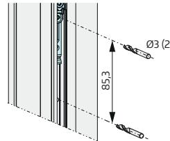
4. Inserire il supporto magnetico nel foro libero del movimento angolare o della chiusura centrale allungabile. Accertarsi che la posizione di installazione del supporto magnetico sia corretta, diversamente potrebbero verificarsi rilevamenti errati.
