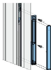
**Nota:** non utilizzare un avvitatore a batteria in quanto una coppia di serraggio delle viti troppo elevata danneggia l'alloggiamento.
