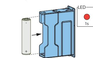
4. L'appareil passe automatiquement en mode appairage, ce qui est signalé par un clignotement du témoin LED. Fermez le compartiment de pile.
