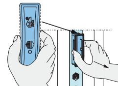
2. Appuyez délicatement sur les languettes en haut et en bas et glissez le capteur dans le creux. Veillez à ce que les informations relatives à Matter ne soient pas endommagées, à ce que la profondeur de fraisage soit suffisante et à ce que les encoches latérales recouvrent le pêne dormant de la serrure. Si nécessaire, il est possible de tourner le capteur à 180 ° pour une meilleure couverture.
