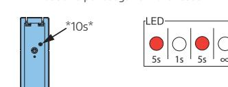
3. Dopo l'hard reset il prodotto passa automaticamente alla modalità Accoppiamento, segnalata dal LED di stato lampeggiante. Proseguire con il passaggio 5 del capitolo "Messa in funzione".
