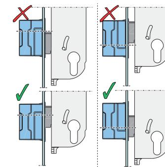
4. Verificare che il sensore riconosca correttamente tutti gli stati del serramento. A questo scopo aprire e chiudere la porta verificando lo stato nella propria app Smart Home.
