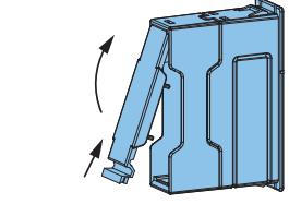
3. Inserire una batteria idonea (AAA 1,5 V, non inclusa nella fornitura). Il LED si illumina brevemente.
