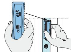
2. Premere con cautela le linguette superiore e inferiore e spingere il sensore nell'incavo. Accertarsi in questa fase di non danneggiare le informazioni specifiche Matter presenti sul sensore, che la profondità di fresatura sia sufficiente e che le tacche laterali coprono la mandata della serratura per porta. Se necessario, il sensore può essere ruotato di 180° per una migliore copertura.
