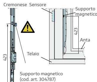
**Nota:** evitare assolutamente l'imbrattamento dovuto a olio, grasso o polvere nonché il contatto con acqua. In caso di imbrattamento pulire con cautela il sensore utilizzando un panno morbido e privo di peli.
