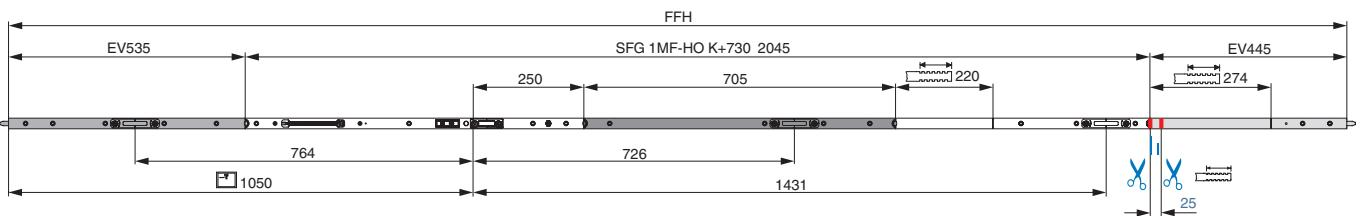
Esempio D: HBB 1900 mm necessario (Altezza maniglia 1050 mm):
