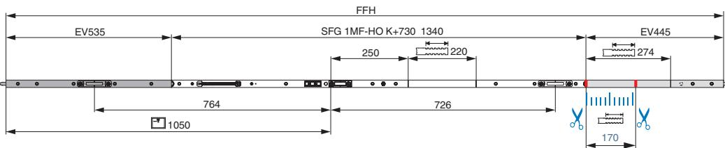
Esempio C: HBB 3000 mm necessario con frontale intermedio (Altezza maniglia 1050 mm):
