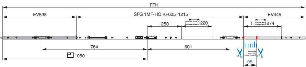
Esempio B: HBB 2400 mm necessario (Altezza maniglia 1050 mm):
