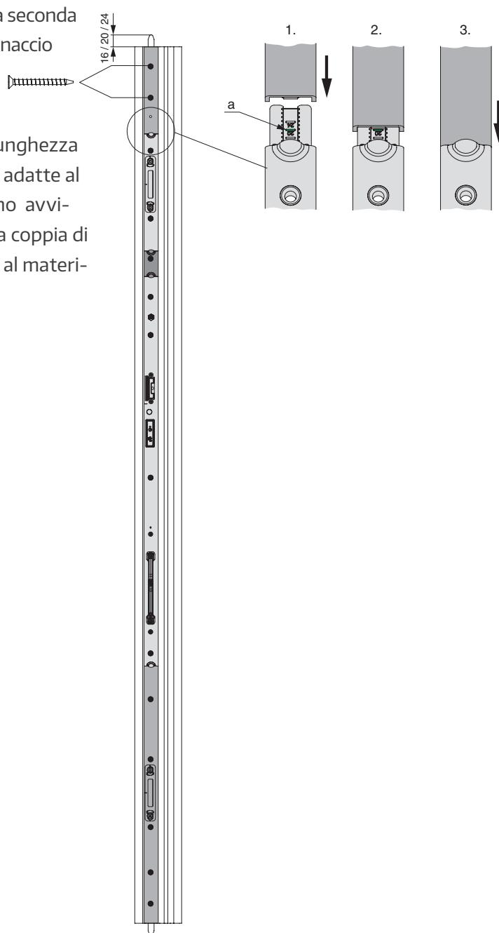
Per il fissaggio utilizzare viti di lunghezza adeguata (diametro max. 4 mm) adatte al materiale del profilo. Le viti vanno avvitate in posizione diritta. Anche la coppia di serraggio deve essere adeguata al materiale del profilo.
