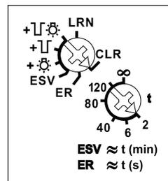
**Mit dem oberen Drehschalter** werden in der Stellung LRN bis zu 35 Funktaster zugeordnet, davon ein oder mehrere Zentralsteuerungs-Taster. Außerdem Funk-Fenster-Türkontakte mit der Funktion Schließer oder Öffner bei geöffnetem Fenster, Funk-Helligkeitssensoren und Funk-Bewegungsmelder. Danach wird damit die gewünschte Funktion dieses Stromstoß-Schaltrelais gewählt:
