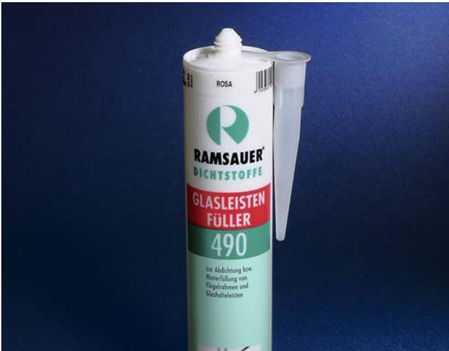
vernetzt bei Zutritt von Luftfeuchte unter Abspaltung von Alkohol zu einer plastischen trockenen Masse, die keine elastischen Eigenschaften aufweist. Diese plastische Silikonmatrix weist keine Eigenhaftung auf Substraten auf und lässt sich daher leicht von diesen abschaben.
