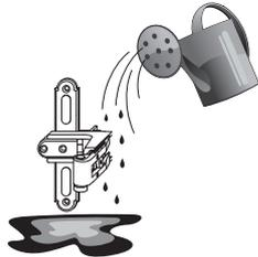
a) Salz- und Staubablagerungen mit Süßwasser reinigen.
