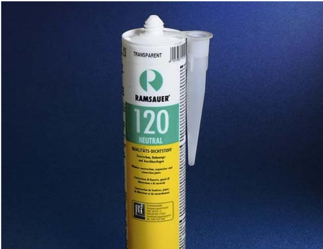
vulkanisiert bei Einwirkung von Luftfeuchte unter Freisetzung eines chemisch neutralen Spaltproduktes, das keine korrosiven Eigenschaften gegenüber Metallen aufweist. NEUTRAL 120 ist geeignet für die Versiegelung von Einscheiben- und Isoliergläsern (auch in Verbindung mit VSG-Scheiben) in Holz- und Metallrahmen sowie für die Abdichtung von Rahmenkonstruktionen.
