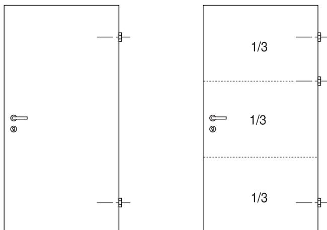
Per aumentare la portata, è assolutamente necessario posizionare la terza cerniera nel terzo superiore della porta.
