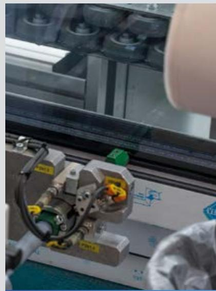
Machine automatique de collage SVEN®. Elle détecte au laser la taille et l'épaisseur de profil de l'élément et s'adapte en fonction de manière automatique.
