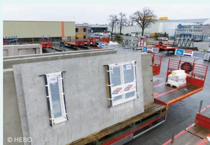
В качестве альтернативы, готовые деревянные каркасные конструкции доставляются непосредственно на бетонные заводы для установки в оконные рамы. На бетонном заводе внутренняя стена «снабжается» оконными рамами. Оконные рамы идеально вписываются в геометрию внутренней стены, сокращая время строительства
