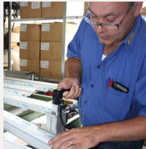
Leo Löffler pokazuje sposób działania tłoczniaka, za pomocą którego obrabia się uszczelki stosowane w nawiewnikach.
